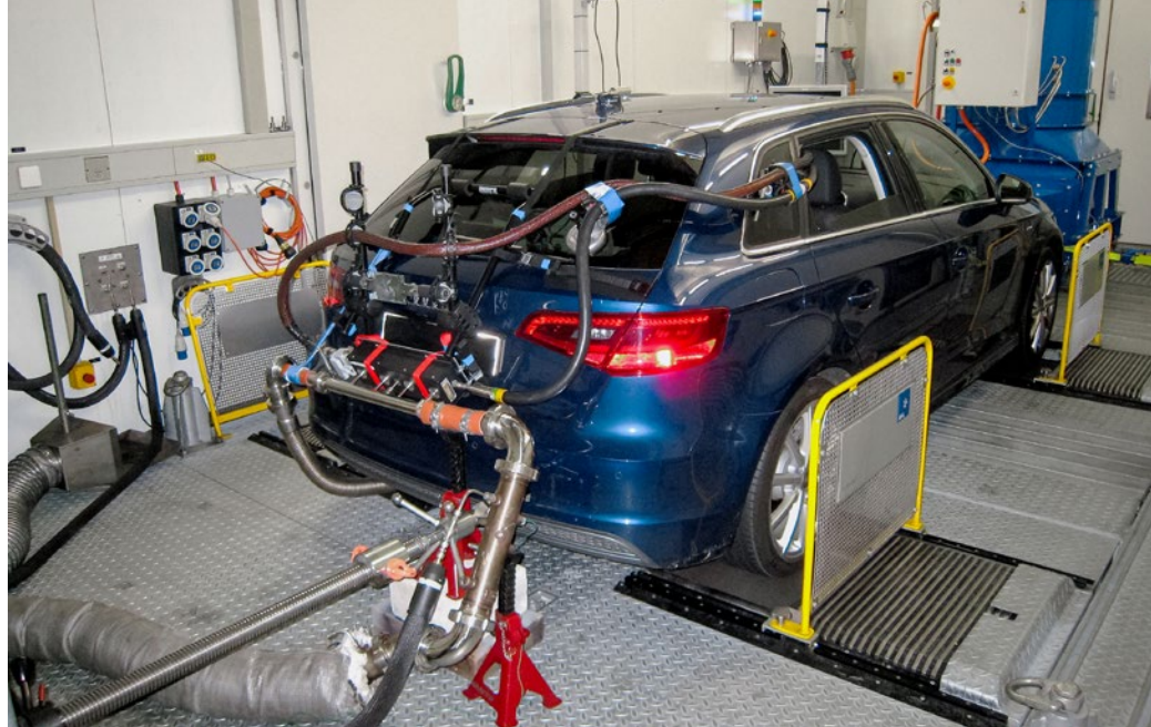
■ Erdgasfahrzeug vom Typ Audi A3 Sportback g-tron auf dem Rollenprüfstand der Empa in Dübendorf. Hier erfolgt die Kalibrierung für eine Abgasmessung im realen Strassenverkehr. Hinten am Fahrzeug ist ein Portable Emission Measurement System (PEMS) montiert. (Foto: Empa)
