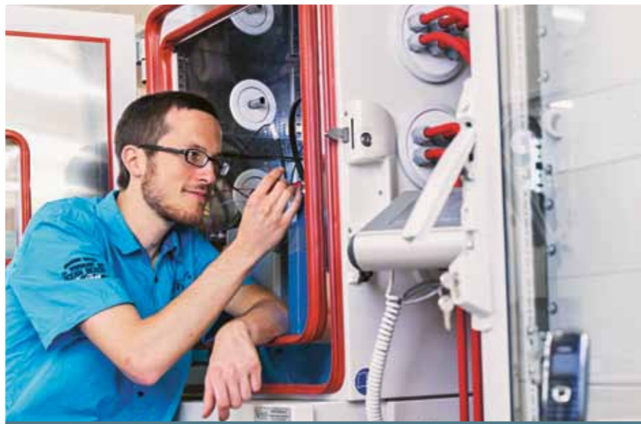
Prüfstand zur Untersuchung des thermischen Verhaltens elektrochemischer Speichersysteme.
