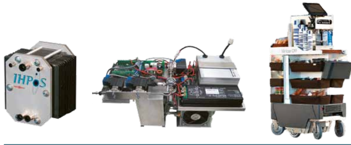
Das Hybridsystem aus der IHPoS-Brennstoffzelle und einer Lithium-Ionen-Batterie wurde an der BFH entwickelt. Fotos: CEKAtec und SBB
