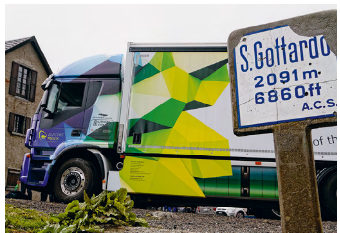
Abb. 1: Der E-FORCE ist der erste elektrisch angetriebene Lastwagen und hat eine Reichweite von über 300 Kilometern. Damit ist es für den regionalen und städtischen Warenverteilungsdienst konstruiert worden. Durch den Einsatz verringern sich nicht nur die CO 2 -Emissionen sondern auch die Lärmbelastung. Quelle: E-FORCE ONE AG
