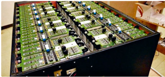
Abb. 3: Die Grossbatterie für den Einsatz in Elektro- und Hybrid-Fahrzeugen. Zwischen den Zellen kann Luft zirkulieren zur Klimatisierung der Batterie. Diese hat eine Spannung von 400 V und eine Kapazität von 16 kWh und ist für Spitzenströme bis 400 A zugelassen. Die Batterie wird durch das integrierte Battery Management System (BMS) ständig überwacht. Foto: Max Stöck, NTB Interstaatliche Hochschule für Technik Buchs
