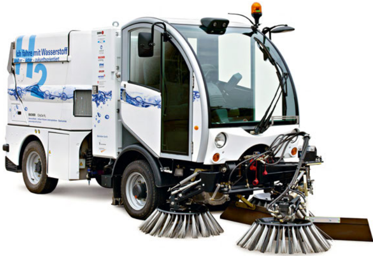
Abb. 2: Die CityCat H2 von Bucher Schörling. Dieses Modell wird bereits heute mit Wasserstoff betrieben. Ein zukünftiges Modell soll mit einem Hybrid-Antrieb ausgestattet werden. Foto: Bucher Schörling AG, www.bucherschoerling.com
